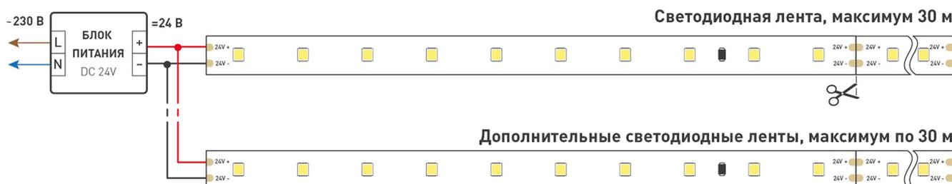
Схема подключения нескольких светодиодных лент с одной стороны.
