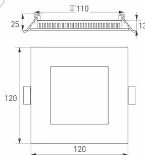
Тонкая панель мощностью 9 Вт в белом квадратном корпусе.
