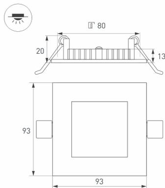
Тонкая панель мощностью 5 Вт в белом квадратном корпусе. Цвет свечения Дневной Белый (4000 К), световой поток 375–400 лм, CRI>80, угол излучения 120°.
