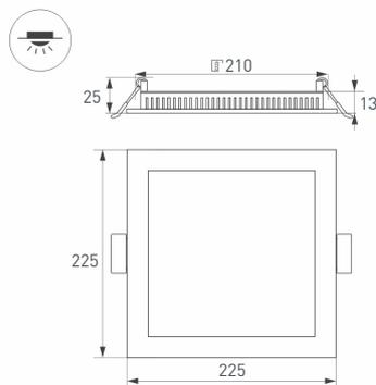
Тонкая панель мощностью 21 Вт в белом квадратном корпусе. Цвет свечения Дневной Белый (4000 К), световой поток 1575–1680 лм, CRI>80, угол излучения 120°.
