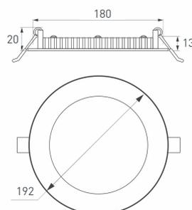
Тонкая панель мощностью 18 Вт в белом круглом корпусе.
