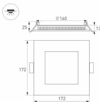
Тонкая панель мощностью 15 Вт в белом квадратном корпусе. Цвет свечения Дневной Белый (4000 К), световой поток 1125–1200 лм, CRI>80, угол излучения 120°.
