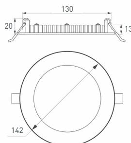
Тонкая панель мощностью 13 Вт в белом круглом корпусе.
