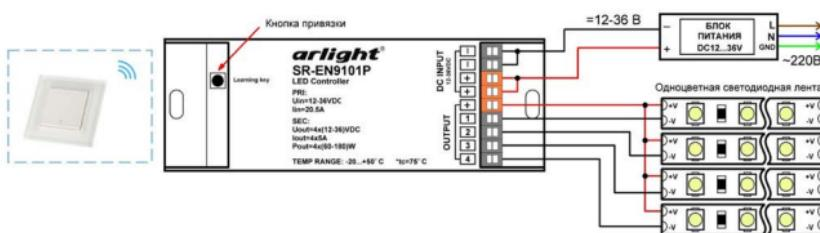
3.3. Подключите диммер и светодиодную ленту (подробнее, см. инструкцию к используемому контроллеру или диммеру).
