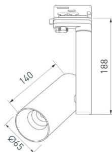
Трековый светильник 8 Вт, черный круглый корпус, черная вставка, металл. Цвет свечения ДНЕВНОЙ 4000 К, св. поток 570 лм, CRI(Ra)>80, угол 40°. Встроенный драйвер PRI: AC 220–240 В, SEC: DC 200 мА, 30–43 В, 8 Вт.
