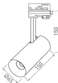
Трековый светильник 8 Вт, черный круглый корпус, белая вставка, металл. Цвет свечения ДНЕВНОЙ 4000 К, св. поток 570 лм, CRI(Ra)>80, угол 40°. Встроенный драйвер PRI: AC 220–240 В, SEC: DC 200 мА, 30–43 В, 8 Вт.
