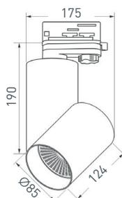
Трековый светильник 15 Вт, черный круглый корпус, цветная вставка, металл. Цвет свечения ДНЕВНОЙ 4000 К, св. поток 1100 лм, CRI(Ra)>80, угол 40°. Встроенный драйвер PRI: AC 100–240 В, SEC: DC 350 мА, 30–43 В, 15 Вт.
