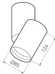
Накладной светильник 15 Вт, черный круглый корпус, белая вставка, металл. Цвет свечения ДНЕВНОЙ 4000 К, св. поток 1100 лм, CRI(Ra)>80, угол 40°. Драйвер встроенный PRI: AC 220–240 В, SEC: DC 350 мА, 30–43 В, 15 Вт. Размеры: Ø120×85×215 мм.
