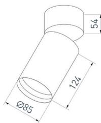
Накладной светильник 15 Вт, черный круглый корпус, белая вставка, металл. Цвет свечения ДНЕВНОЙ 4000 К, св. поток 1100 лм, CRI(Ra)>80, угол 40°. Драйвер встроенный PRI: AC 220–240 В, SEC: DC 350 мА, 30–43 В, 15 Вт. Размеры: Ø85×185 мм.
