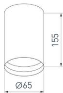
Накладной светильник 8 Вт, черный круглый корпус, черная вставка, металл. Цвет свечения ДНЕВНОЙ 4000 К, св. поток 570 лм, CRI(Ra)>80, угол 40°. Встроенный драйвер PRI: AC 220–240 В, SEC: DC 200 мА, 30–43 В, 8 Вт. Размеры: Ø65×155 мм.
