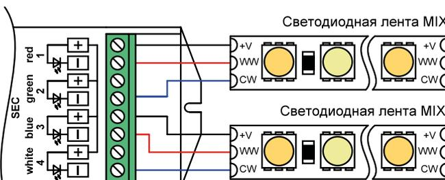
Рис.4. Подключение светодиодной ленты MIX
