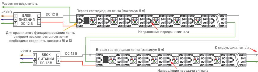
Рис. 1. Схема подключения ленты без использования внешнего контроллера (максимум 1024 пикселя, общий рисунок динамического эффекта при переходе с ленты на ленту сохранится)
